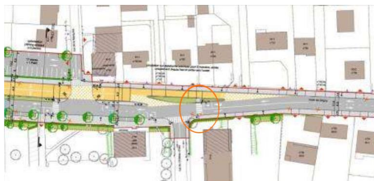
Plan d'aménagement du carrefour site propre-site banalisé
